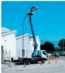
Consta de una estructura articulada o telescópica, capaz de elevarse a alturas de más de 100 m y de girar 360°. La plataforma puede ser utilizada por varios operadores según los casos.
